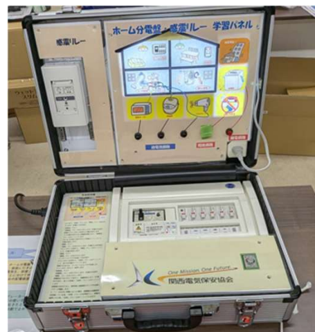
感震ブレーカーモデルキット ブレーカーや、感震ブレーカーのはたらきを点灯するライトやスイッチの操作で理解できる仕組み。
