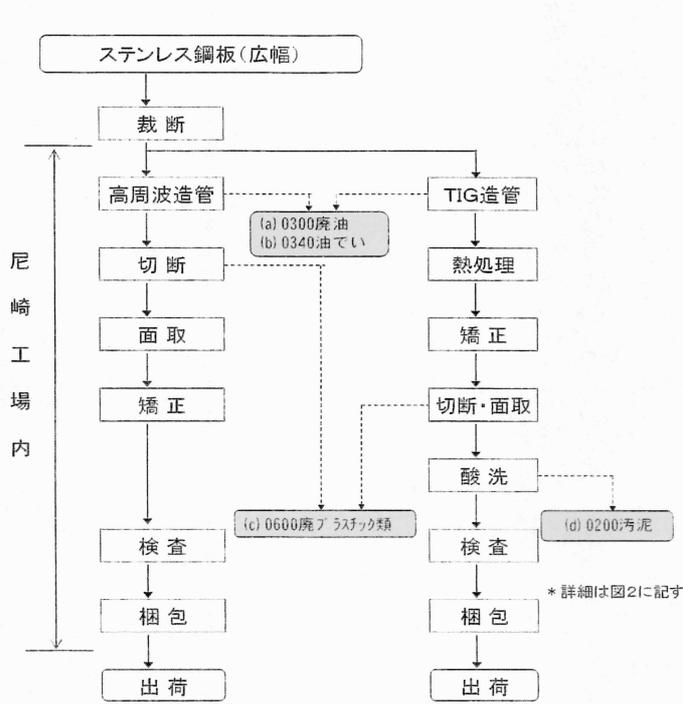
図1 ステンレス鋼管製造フロー
