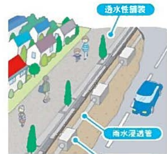
雨水浸透施設の整備
