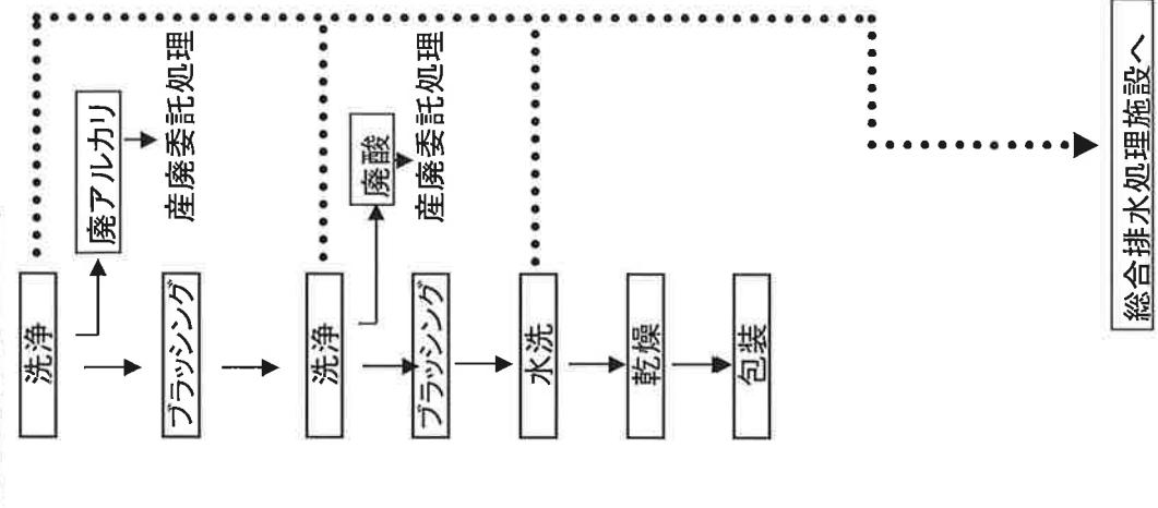
(3)治工具の洗浄工程
