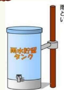
雨水貯留タンクの設置
