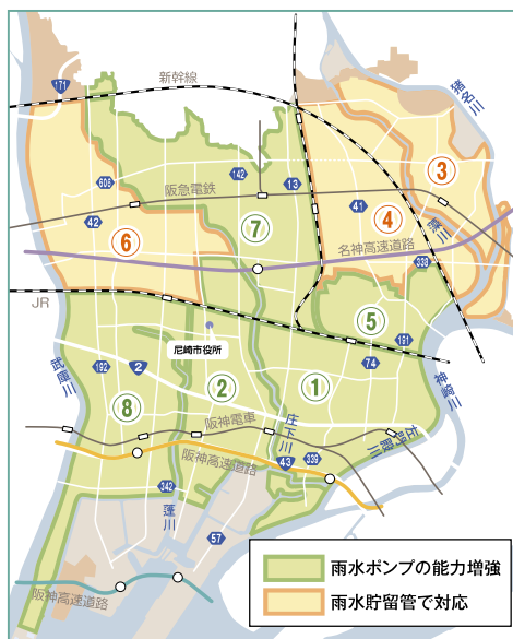
ポンプ能力を増強すると雨水を河川へ吐き出す量が増えます。
