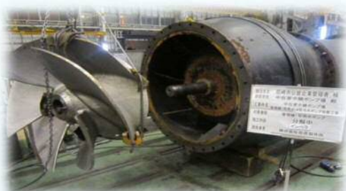
【雨水ポンプ設備の整備前】
