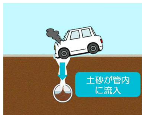
【陥没のメカニズム】
