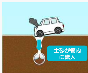
陥没のメカニズム (出典：東京都下水道)
