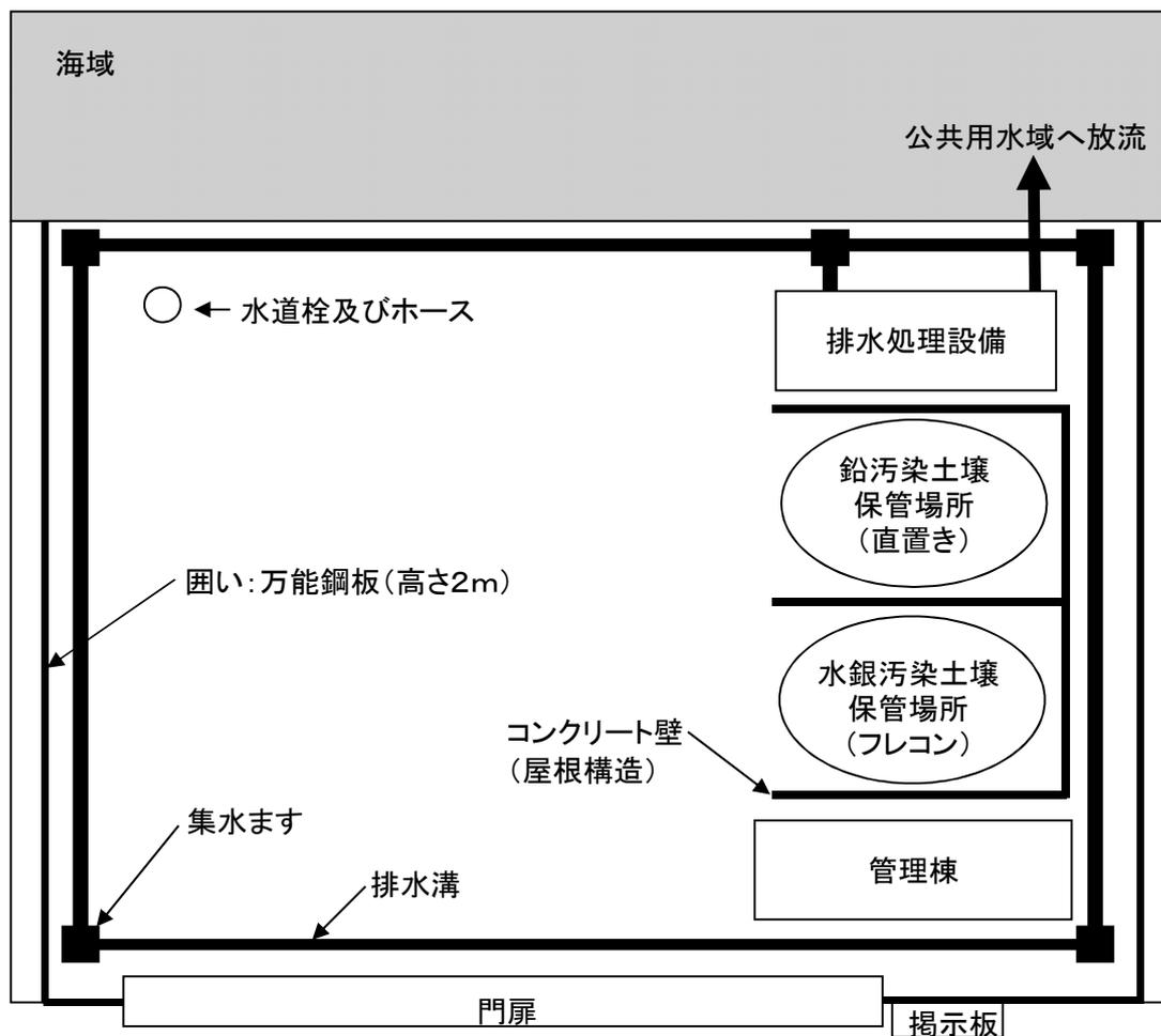
※施設床面は全て厚さ15cmのコンクリートで舗装されている。
