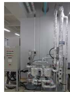
酵素法による 連続バイオディーゼル製造装置 （Bio-energy 株式会社）
