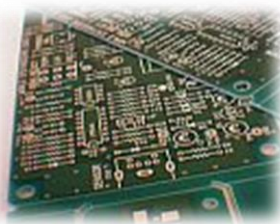
▼ 製造されたプリント基板
