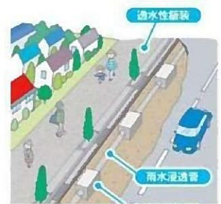
雨水浸透施設の整備
