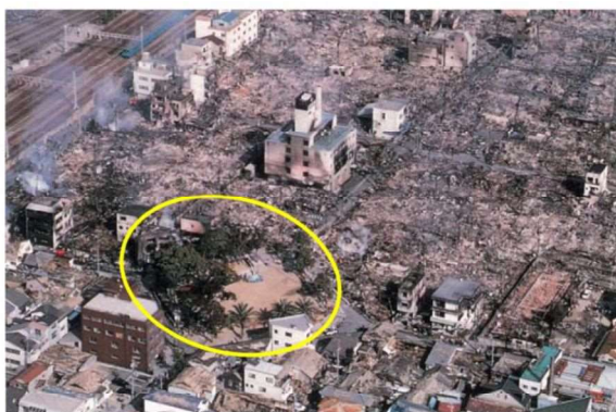
公園・緑地による災害時の延焼防止の例 (神戸市大国公園 国土交通省)
