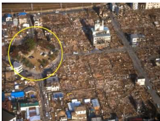
公園・緑地による災害時の延焼防止の例 (神戸市大国公園)
