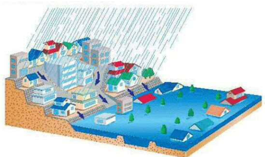
地表がコンクリートやアスファルトで覆われたり、森林や水田・ため池がなくなることにより、雨水が短時間に集中して河川へ流出し、浸水被害が増加します。
