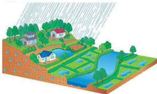
雨水の大半は地中に浸透したり、水田やため池に貯留され河川への流出は抑えられます。
