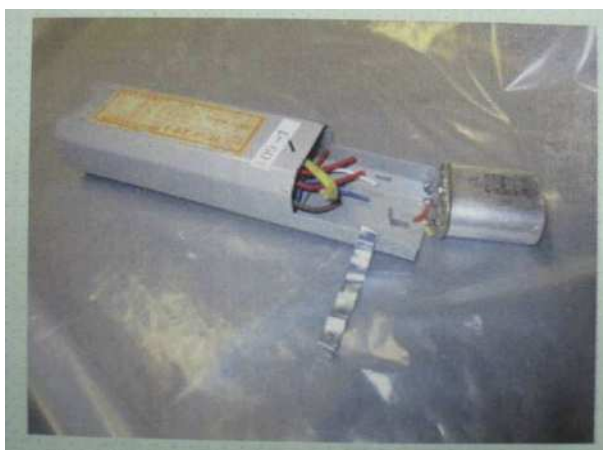
安定器内にあるコンデンサの 配置状況
