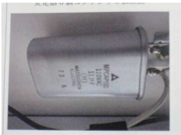
コンデンサ本体 (PCBはコンデンサ内に密封されている)
