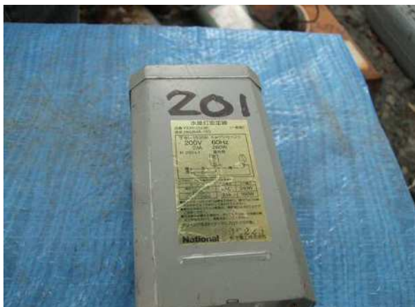
紛失した水銀灯安定器と同型のもの 縦×横×高さ : 8cm × 8cm × 26cm 重さ : 4kg
